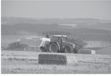
الشكل (٢٨-١): أحد أنواع مكابس البالات الحديثة المستطيلة المقطع.
