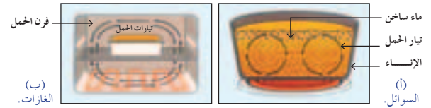
الشكل (٣-٣): طرائق انتقال الحرارة بالحمل في السوائل والغازات.
