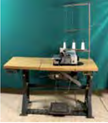
الشكل (٢-٥٢): الأجزاء المثبتة على طاولة آلة الحبكة.
