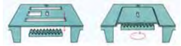
الشكل (٢-٢٧): إلغاء حركة مشط التغذية.
