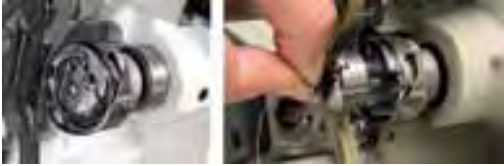
الشكل (٢-٤٢): حافظه المكوّك في آلة الدرزة الصناعية.
