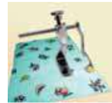
الشكل (٣-٣٦): القدم الضاغطة الخاصة بضبط المسافات.
