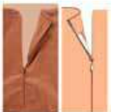
الشكل (٣-١٨): التركيب المخفي للسحاب.
