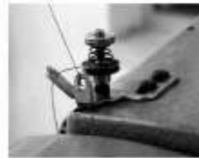
الشكل (٢-٥٩): منظم شد خيط تعبئة المحرك.
